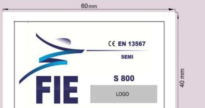
在标识区域，器材生产商的名字将被显示。在上衣、裤子及保护背心上缝制 S 800 的标记。面罩上缝制 M1600 标记。器材上芯片和标记的安装位置如下图所示。Fig.3。
